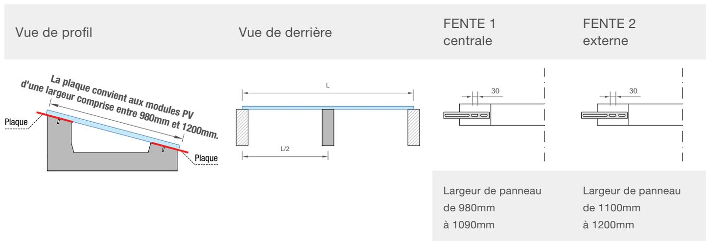
**UTILISER L'UNE DES DEUX FENTES DE 30 MM POUR FIXER LA PLAQUE AUX BALLASTS CENTRAUX DE RENFORT EN FONCTION DE LA LARGEUR DU PANNEAU**
