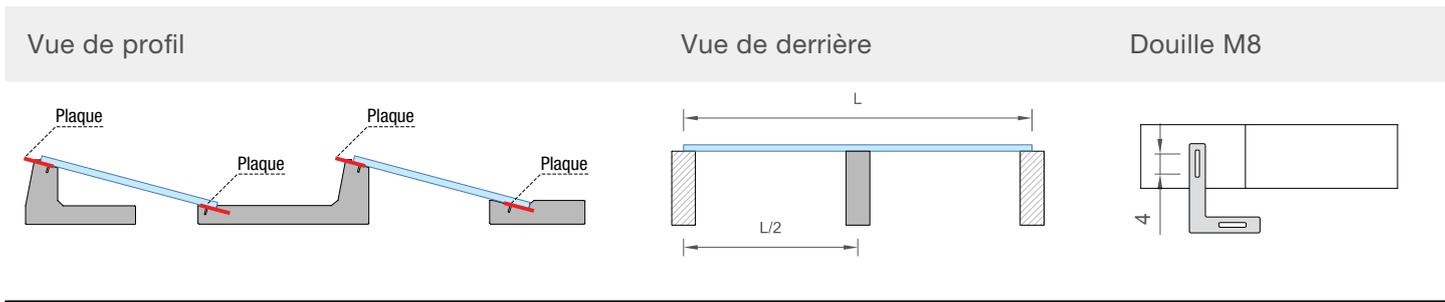
**UTILISER LA FENTE DE 4CM POUR FIXER LA PLAQUE AUX BALLASTS CENTRAUX DE RENFORT**
